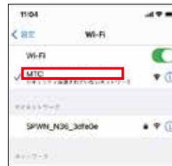
アプリ起動せずにスマホの「設定」→「Wi-Fi」を開きカメラの信号を選択し接続します。
