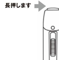
電源ボタンを長押ししますと青ランプが点灯し、ボタンを放します。その後自動で録画を開始。電源ボタンを一度押すと停止します。青ランプ点灯で待機状態になります。待機状態で電源ボタン押し続けますと（約5秒間）電源がオフになります。待機状態では約1分間以上操作がない場合は自動電源オフになります。
