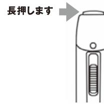
電源をオフにした状態で電源ボタンを長押ししますと青ランプが点灯した後、緑ランプが数回点滅後に消えオート録画が開始します。録画中に電源ボタンを1回押しますと録画が停止し青ランプが点灯の録画待機状態になります。連続録画の場合メモリー容量がいっぱいになった時点で録画が停止し、電源がオフになります。
