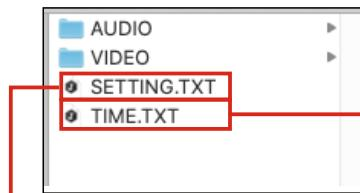
本体に入ってるTIME.TXTを開くと、**2020-04-20,23:59:59**と書かれたテキストファイルが開きます。時刻を設定します。数字を打ち替えます。書式などは変更しないで下さい。(半角英数字) 保存して閉じると各機能が変更され、次回から反映されます。
