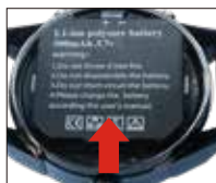
バッテリー上の矢印反対方向へ押しながらバッテリーを外します。
