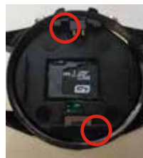
裏蓋は手で逆時計方向へねじることで開けられます。
