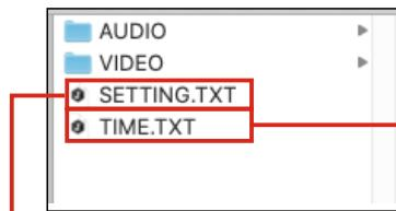
本体に入ってるTIME.TXTを開くと、**2020-04-20,23:59:59**と書かれたテキストファイルが開きます。時刻を設定します。数字を打ち替えます。書式などは変更しないで下さい。(半角英数字) 保存して閉じると各機能が変更され、次回から反映されます。
