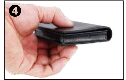
④ 穴の位置とレンズがずれないようにしっかりと指で押さえて撮影をします。
