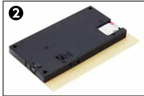
② 穴の位置にレンズを合わせてカメラを厚紙に両面テープなどで固定します。
