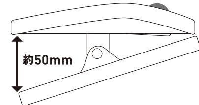
**ブラケット:** ブラケットを壁面に取り付けます。付属のビス、必要であればアンカーボルトを使用して壁面に取り付けます。取り付ける壁に合わせてご使用下さい。本体のジョイント穴とブラケットを奥までしっかり差し込んで完了です。
